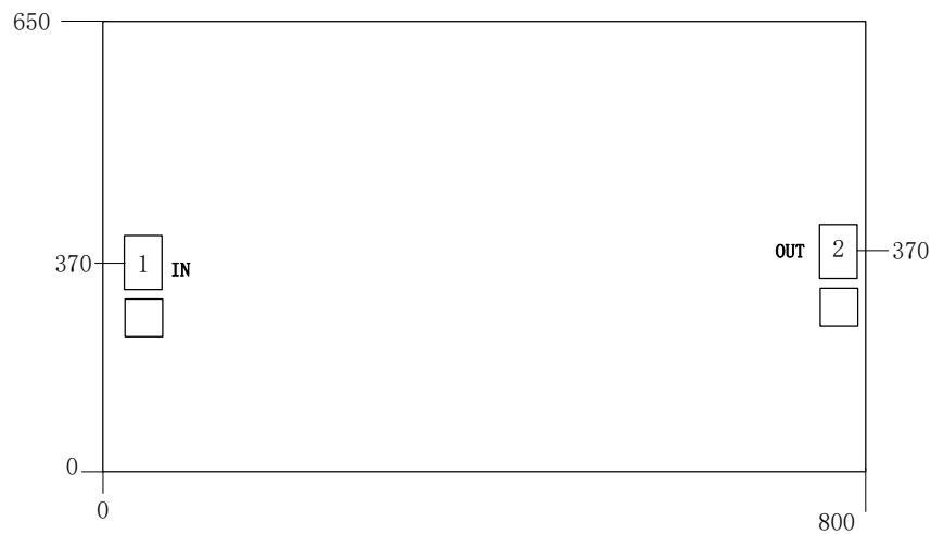
芯片端口图 (单位: \mu\text{m} )
