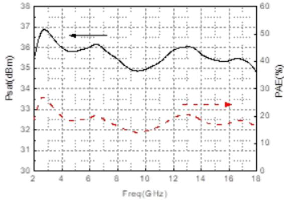
饱和输出功率 vs. 频率 (Pin=20dBm-29dBm)
