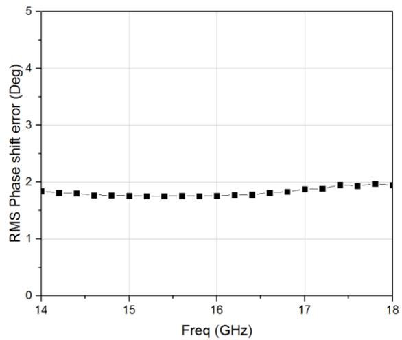
发射模式 RMS 移相误差 vs 频率
