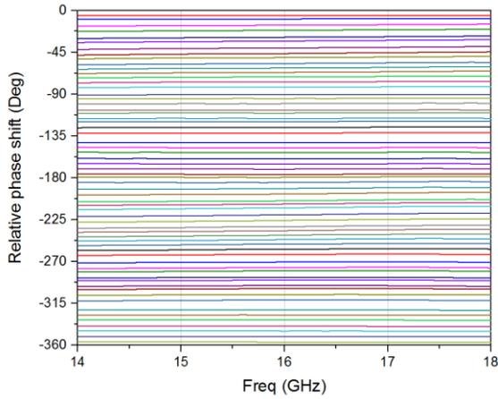
发射模式 64 态相对移相曲线 vs 频率
