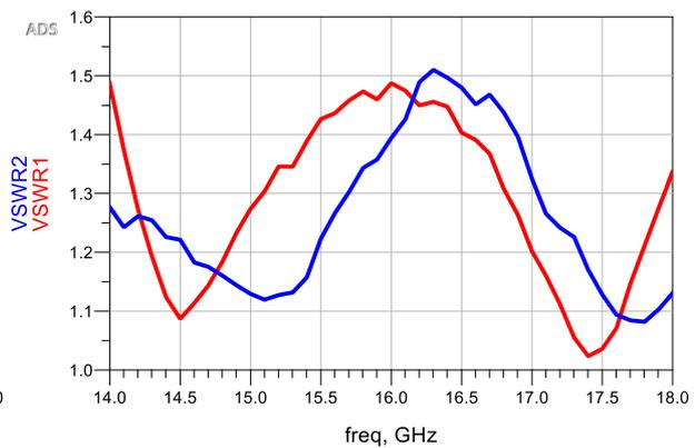
发射模式端口驻波比 (COM 为 1 端口)
