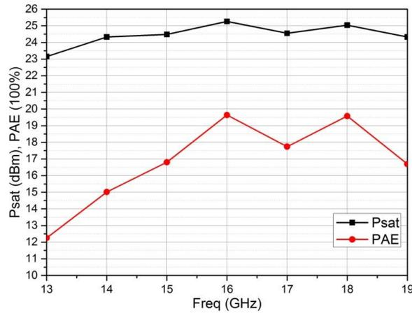
发射输饱和功率，效率 vs 频率
